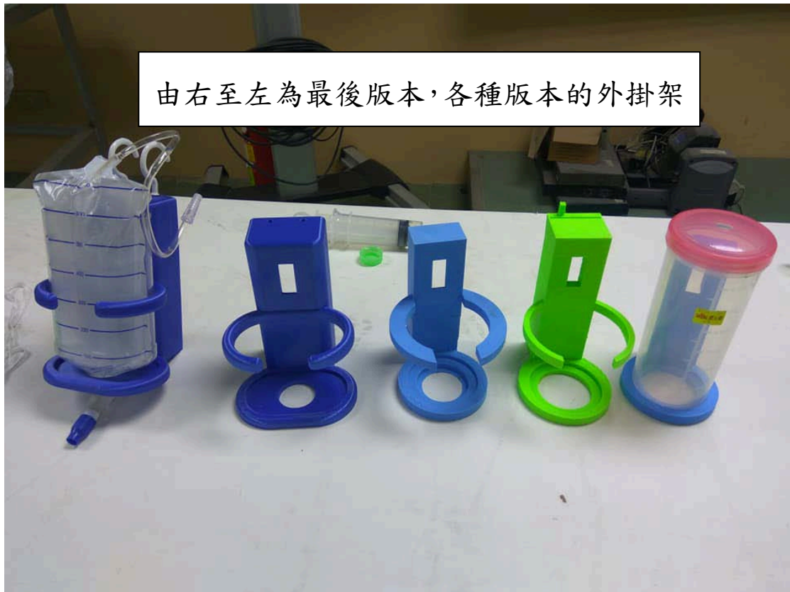
圖 7-3. 電繪軟體，設計列印出各版本外掛式架。
