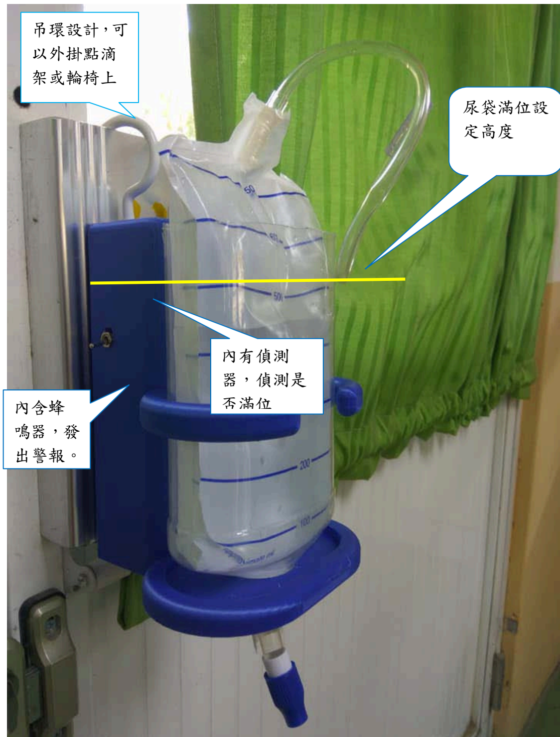
圖 1. 外掛式尿袋滿位偵測器可以吊掛處便可以使用。
