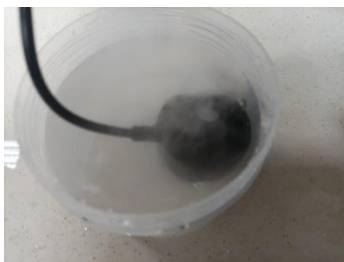
圖 29：超音波霧化器霧化冷凝水。
