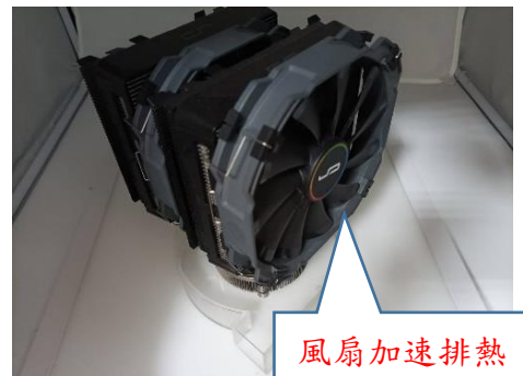
圖 19：導管外以風扇加速熱排出
