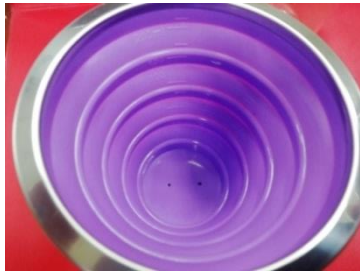
圖 18：二版設計，以三等分圓周方式，打二個直徑 1mm 小孔。
