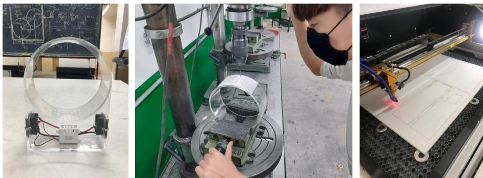
圖 19：小組操作銑床和鐳雕機製作壓克力元件
