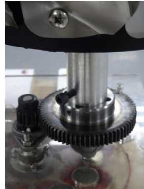
圖 21：改裝連軸器，在軸心不變下，可帶動大齒數比
