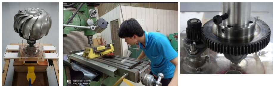
圖 16：車、銑床實作施工，改製連軸器，以提高齒數比。
