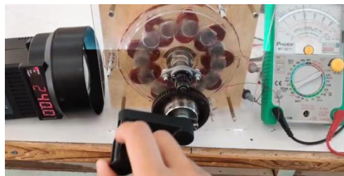
圖 20：先手搖方式測轉速與發出電量。
