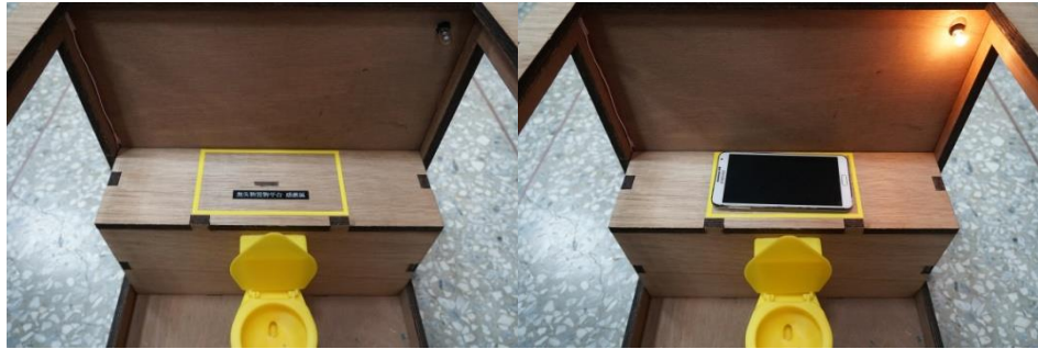
圖 17：增設無失物置物台設計，當手機放上時燈亮啟動。
