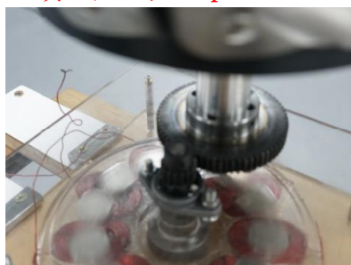
圖 26：排風器 64 齒帶動發電機 16 齒軸心
