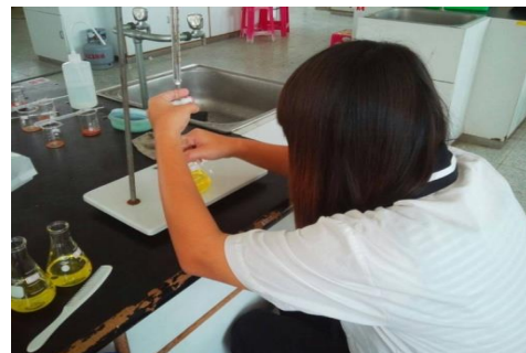
圖 8、以已知濃度 \text{AgNO}_3 溶液滴定至終點，記錄滴定毫升數計算得之試料鹽度。
