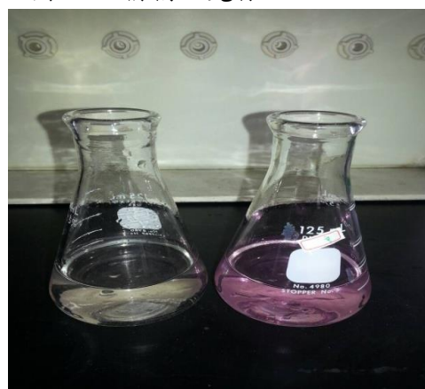
圖 25、以福魯吸管吸取 10 毫升之試料溶液兩份(二重複)至三角瓶中，加入 50 毫升蒸餾水和酚酞指示劑 2~3 滴。
