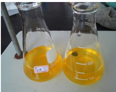
圖 7、以福魯吸管吸取 10 毫升試料溶液兩份(二重複)至三角瓶中，加入 50 毫升蒸餾水和 \text{K}_2\text{CrO}_4 指示劑 2~3 滴。
