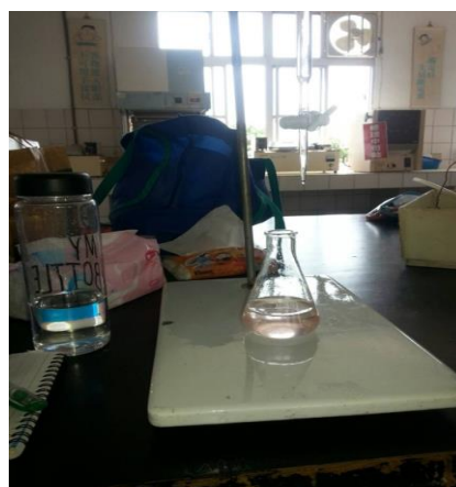
圖 21、以已知濃度 NaOH 溶液至三滴定至終點，記錄滴定毫升數計算得之試料酸度。
