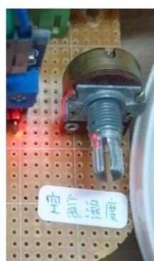
▲圖 4-1 實際空氣防燥系統      ▲圖 4-3 模擬空氣濕度系統，以 85KΩ 代替。
