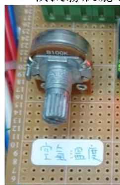
▲圖 2-3 模擬空氣溫度系統，以 100KΩ 代替
