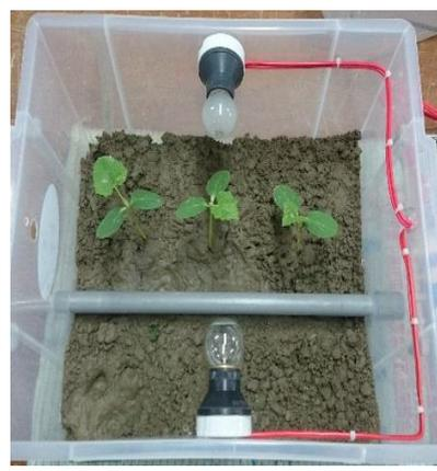
▲圖 7-2 交替補強照度燈泡
