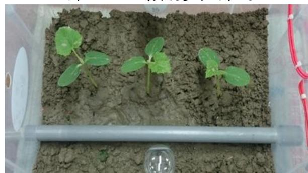
▲圖 3-3 模擬土壤柱狀噴水系統
